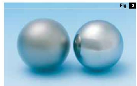
L'aspect mat de la surface de la bille signale la présence de micro-cratères
