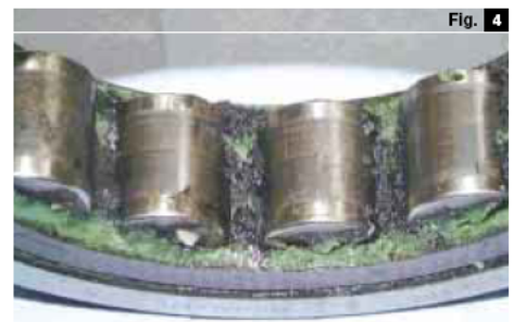
Graisse noircie par les décharges électriques à hautes fréquences
