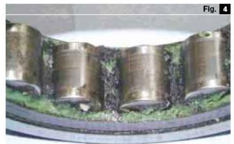
Graisse noircie par les décharges électriques à hautes fréquences
