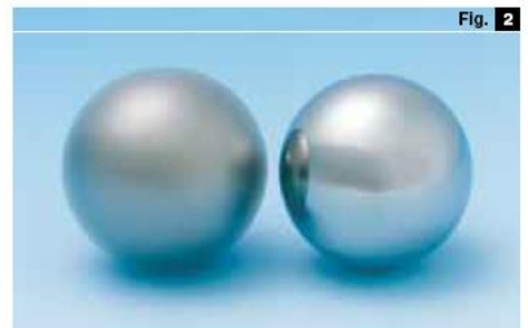
L'aspect mat de la surface de la bille signale la présence de micro-crâtes
